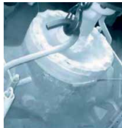
LG3 – криогенное испытание регулирующего клапана
