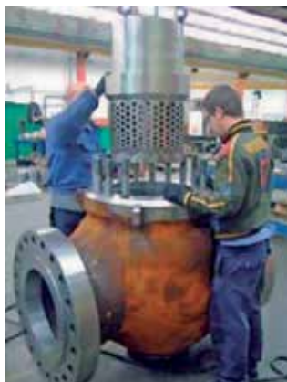
LG3 – Установка клетки
